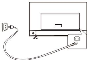
2. Conecte el cable de alimentación PRIMERO al televisor, Y SÓLO DESPUÉS, a una toma de corriente. (**Nota:** Si el cable de alimentación está conectado al televisor, conéctelo solamente a la toma de corriente).
