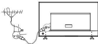
3. Conecte una antena externa en la toma de entrada para ANTENA/CABLE de la parte trasera del TV.
