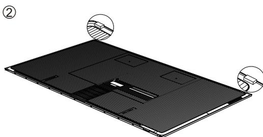
Nota: Antes de colgar el televisor en la pared, coloque la goma en la posición que se muestra en la ilustración.
